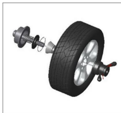
Montážny kužeľ hlavného hriadeľa (veľká vnútorná hlava) -
